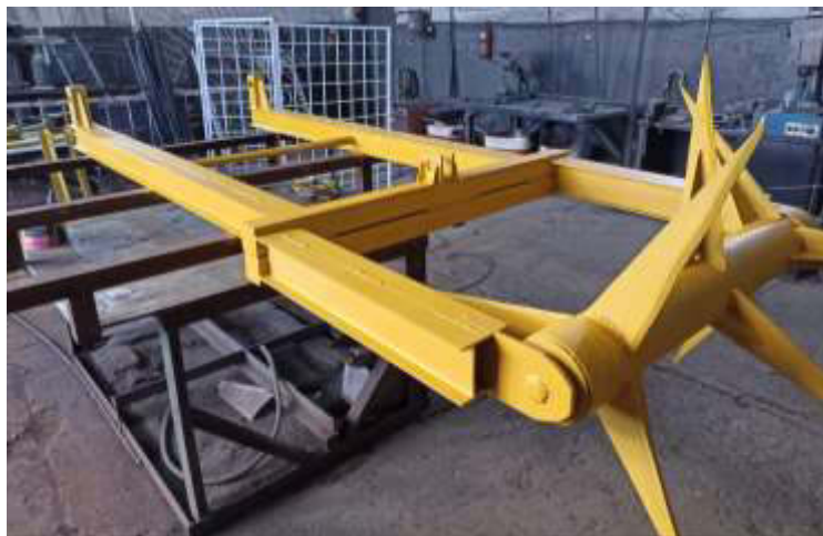
Рисунок 1 - Общий вид фронтального прокальвателя-щелереза в сборе
